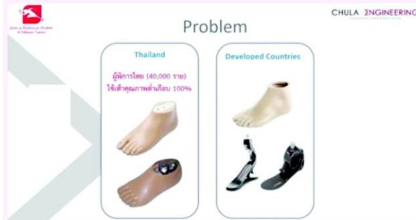
เท้าเทียมธรรมดา (ซ้าย) - เท้าเทียมจากวัสดุคาร์บอนไฟเบอร์ (ขวา)
